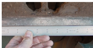
Износ звена при использовании направляющего колеса с плоским ободом
