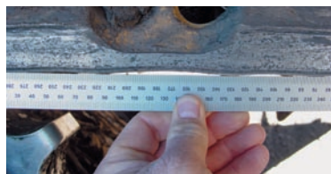
Износ звена при использовании обычного направляющего колеса
