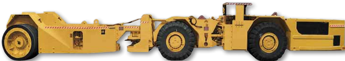
Прицеп механизированной крепи SH150 для моделей CL210 и CL215
