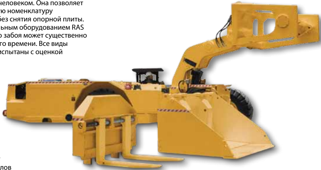
RAS: быстрая сценка и разъединение дополнительного оборудования
